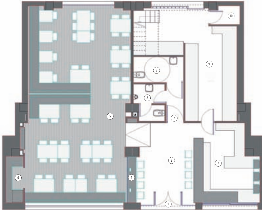
1. Entrada/Entrance 2. Barra principal y contrabarra/Main and back bar 3. Zona de espera/Waiting zone 4. Barra y zona de catas/Bar and wine tasting zone 5. Comedor/Dining room 6. Office/Office 7. Vestíbulo de aseos/Rest room foyer 8. Aseos/Rest-rooms 9. Cocina/Kitchen 10. Cuarto de basura/Rubbish room.
